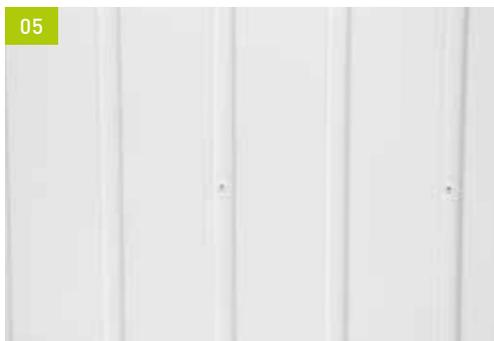
[05] Alle Stahlteile sind verzinkt, der Torbelag mit Nieten in Torfarbe am Torblattrahmen befestigt. Die endbehandelte Oberfläche mit organischem Polyester beschichtet, trägt zur langen Werterhaltung des Tores bei und gibt dem Rost ebenfalls keine Chance. Der Torbelag des Tores besteht aus einem gesickten T10 Trapezprofil.
